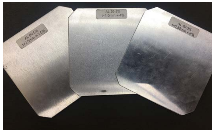
รูป 5 แผ่นอลูมิเนียม (Aluminum plates, Al) ขนาด 0.5, 1.0 และ 2.0 มิลลิเมตร
