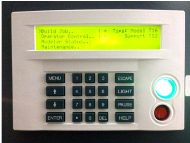
รูปที่ 13 แสดงหน้าจอของเครื่อง FDM เพื่อการสร้างชิ้นงาน
