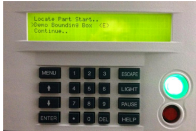
รูปที่ 16 แสดงหน้าจอของเครื่อง FDM เพื่อกำหนดตำแหน่งที่ทดสอบการสร้างชิ้นงาน
