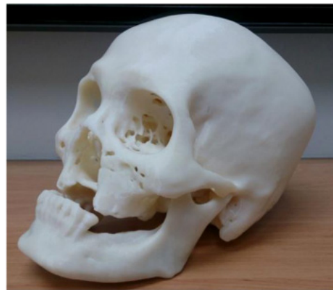
รูปที่ 12 แสดงหลักการสร้างภาพของระบบ FDM และชิ้นงานที่ผลิตได้จริง
