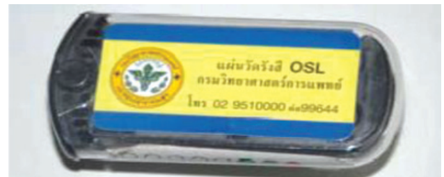
รูปที่ 8 แสดงแผ่นวัดรังสีชนิด Optical Stimulated Luminescent Dosimeter (OSL)
