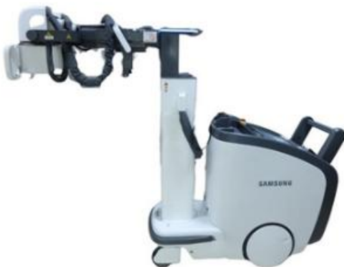
รูปที่ 3 เครื่องเอกซเรย์ full size DR portable (ยี่ห้อ Samsung) และตัวรับภาพชนิด Detector
