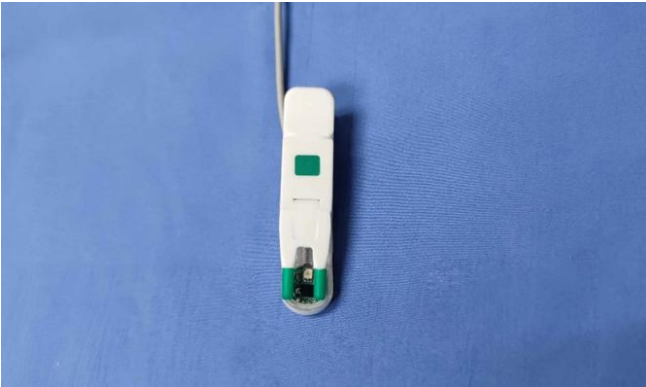
รูปที่ 2 หัวตรวจคลื่นแสงอินฟราเรด (Photoplethysmography) ที่มา หน่วยตรวจอัลตราซาวด์ สยามินทร์ ชั้น 1 โรงพยาบาลศิริราช
