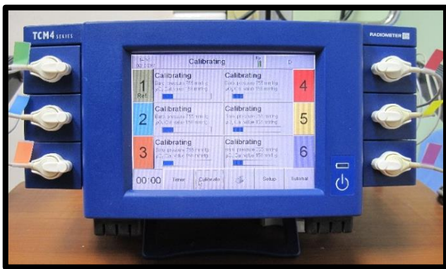
รูปที่ 2 เครื่องตรวจวัดค่าความดันของออกซิเจนบริเวณผิวหนัง ที่มา : ถ่ายโดย โชนันธนา ศรีปริทัศน์
