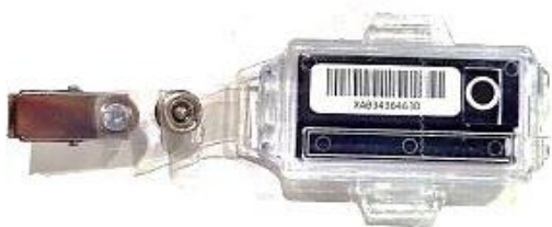
ภาพที่ 1 เครื่องวัดรังสีประจำตัวบุคคลชนิด Optical Stimulated Luminescent (OS)
