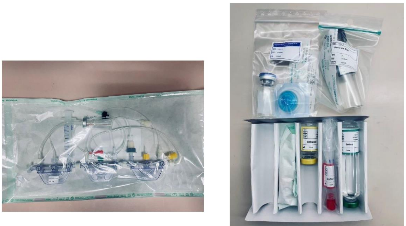
ภาพที่ 2 Cassette, Reagent kits และอุปกรณ์ต่างๆที่ใช้ในการสังเคราะห์สารเภสัชรังสี ^{68}\text{Ga} -PSMA-11
