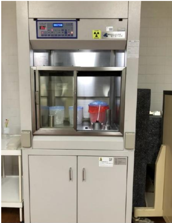
ภาพที่ 3 ตู้ดูดควันสำหรับบริหารสารเภสัชรังสี ชนิดมีคาร์บอนฟิลเตอร์ ตามมาตรฐานห้องปฏิบัติการทางรังสี
